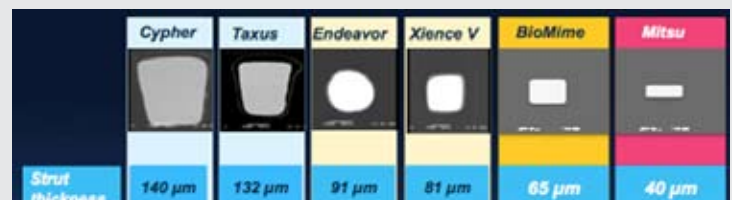
Fig 2: Espessura das Hastes de diferentes stents coronários
